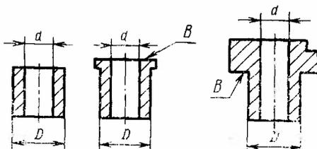
5. Радиальное биение поверхности  $d$  относительно поверхности  $D$ , не должно превышать величин, указанных в ГОСТ 10356—63: для втулок с предельными отклонениями на размер  $D$  по 2-му классу точности — по IV степени;
