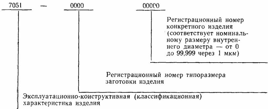
Указание степени точности внутреннего диаметра втулки  $d$  производится припиской символа класса и степени точности (посадки) в конце цифрового обозначения.
